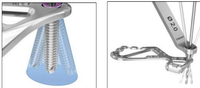
Figura 9: La tecnología de bloqueo de ángulo variable permite colocar los tornillos en cualquier lugar dentro de un cono de 30° alrededor del eje central del orificio de la placa (15° fuera del eje en cualquier dirección).
